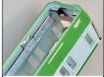
側窓下の通電の確実を期して、2.5mm×10mmのアルミテープを重ね貼ります。
