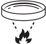
凸レンズは、虫眼鏡のように光を集中させます。決して光源を直視しないでください。網膜損傷の危険性・失明を招く恐れがあります。レンズ面を太陽やその他のフィクチャーの強い光源に向けしないでください。強い光は、フィクチャーの内部損傷を引き起こし、数秒以内にコンポーネントを溶かしたり、内部火災を発生させることがあります。日中の屋外で使用する場合は、照明器具の前面が遮光されているか、または太陽から遠ざかっていることを確認してください。
