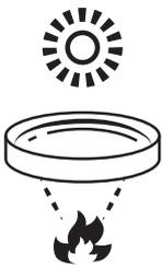
凸レンズは、虫眼鏡のように光を集中させます。決して光源を直視しないでください。網膜損傷の危険性・失明を招く恐れがあります。レンズ面を太陽やその他のフィクスチャーの強い光源に向けないでください。強い光は、フィクスチャーの内部損傷を引き起こし、数秒以内にコンポーネントを溶かしたり、内部火災を発生させることがあります。日中の屋外で使用する場合は、照明器具の前面が遮光されているか、または太陽から遠ざかっていることを確認してください。
